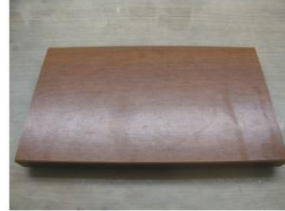
1 adet 15 cm. x 25 cm. Ölçülerinde sunta / MDF veya masif ağaç parça. Marangozlardaki artık parçalardan olabilir. Renk farketmez, temiz ve düzgün olması yeterli. Standart 18 mm. Kalınlığında olanlar uygundur.
